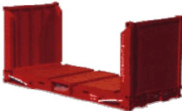
Uso habitual: Cargas difíciles de manipular, bobinas de metal, cables, vehículos pesados, madera, maquinarias especiales, etc.
